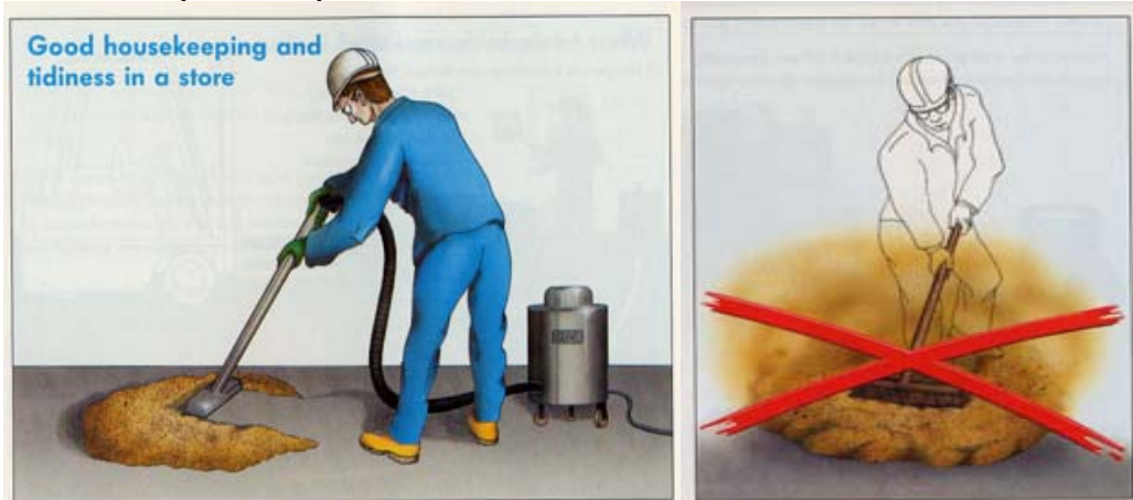
Figura 3.2: Eliminazione dei depositi di polveri 4 .
