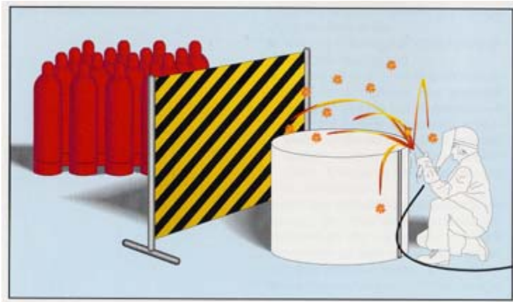
Figura. 4.2: Esempio di schermatura nel corso della produzione di scintille 4
