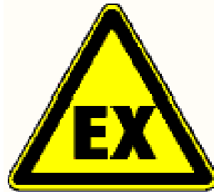
Figura 4.3: Segnale di avvertenza per indicare aree a rischio di esplosione.
