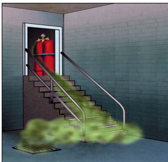
Figura 2.3: Modalità di propagazione dei gas liquefatti (esempio) 4
